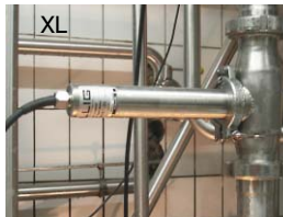
Beispiele COSMOS ® -25 Typ ETC, Typ VARI für Varivent ® oder Typ XL für Tri-Clamp ® Anwendungen
